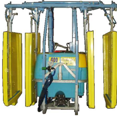
S21 - Panneaux récupérateurs
