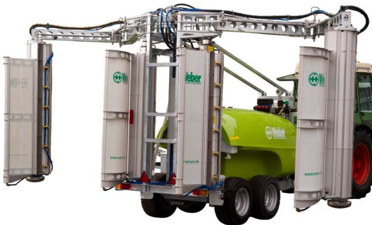
WEBER – descentes avec panneaux récupérateurs
